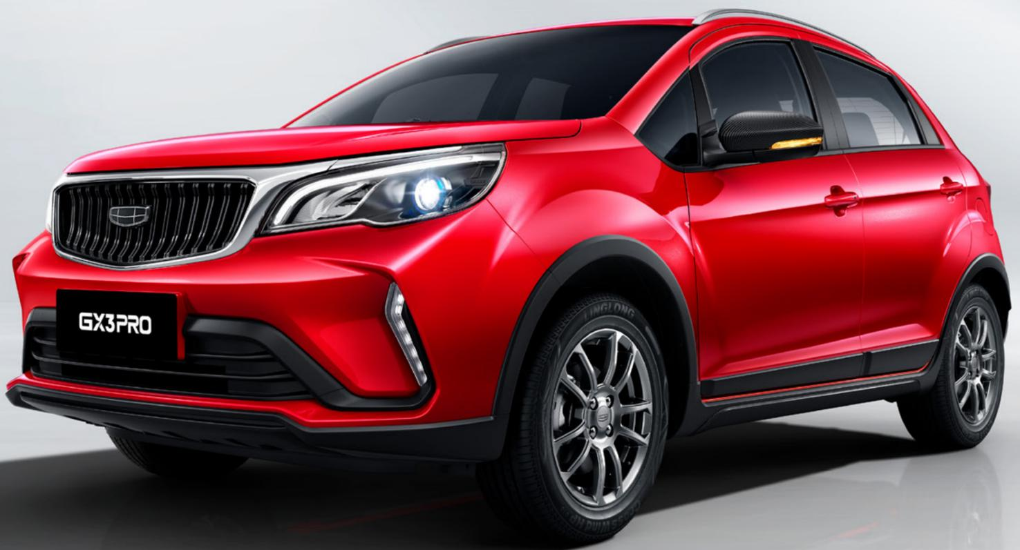
Geely GX3 PRO posee un motor de 1.5 litros y 16 válvulas con una potencia de 102 caballos de fuerza. Se comercializa en tres versiones: GB Manual, GC Manual de 5 marchas (con techo solar y control crucero) y su versión automática GF con una caja CVT de 8 marchas que incluye tres modos de conducción: Eco - Normal - Sport.
