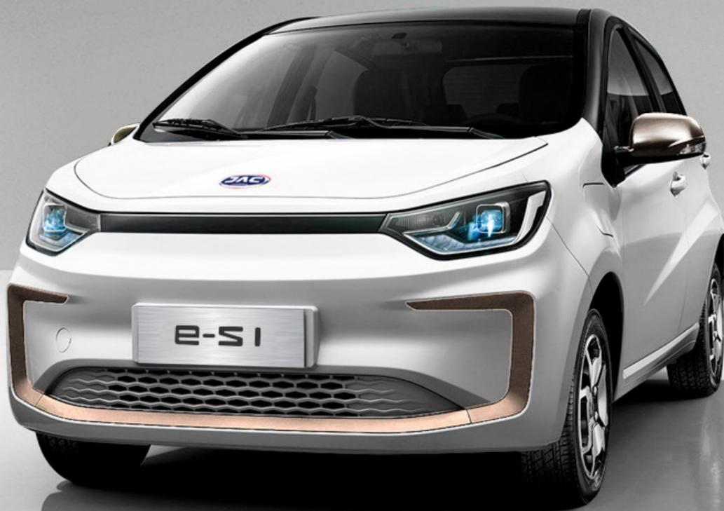
JAC ES1 es un city car compacto 100% eléctrico con una batería de iones de litio de 30,2 kWh que permite una autonomía de 302 km NEDC. Pensado para quienes buscan un rendimiento excepcional obteniendo un menor costo por kilómetro recorrido. Su batería de iones de litio tiene 8 años de garantía y ofrece una autonomía muy destacable.
